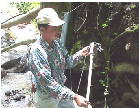
Fig. 2. Sensor basado por contactos de metal ( colocados a cierta distancia) que con el contacto del agua por ascenso de nivel cierran un circuito eléctrico que ligado a panel digital numérico muestra el nivel a que se encuentra el río en un determinado momento .
