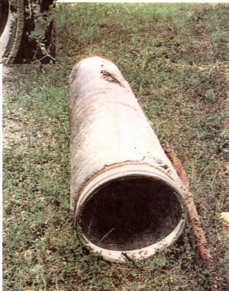
Fotografía 3.4 Detalle de la composición del tubo de concreto reforzado de 500 mm
